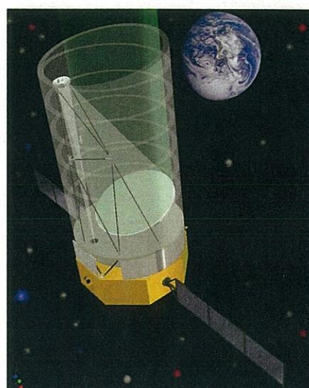
▲コロナグラフを応用した高コントラスト宇宙望遠鏡の案。口径約3.5mの軸外しの1枚鏡をH-IIAロケットのフェアリングに収めて、太陽-地球の第2ラグランジュ点まで打ち上げます。
